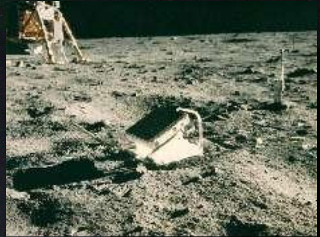
Apollo 11 retroreflector array
